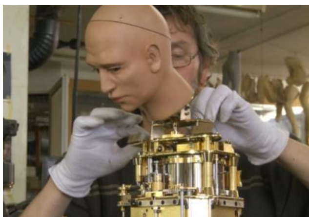
Réglage du mécanisme sur un androïde écrivain dessinateur © Alain Margot
