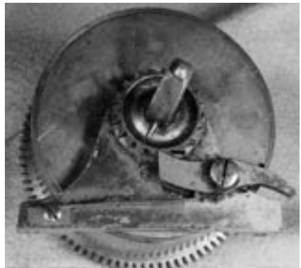
Illustration 5 - Encliquetage, façon soignée de son ressort.
